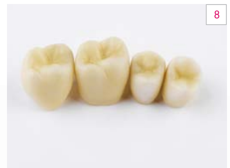
Abb. 8 Restaurationen nach dem Sinterbrand und vor der finalen Charakterisierung mit VITA AKZENT Plus Malfarben.
