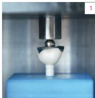
Abb. 1 Die Kronen wurden bis zum Bruch belastet.
