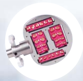
Abb. 3 Die CAM-Bearbeitung der Prothesenzähne erfolgt analog zur Konstruktion basal und zirkulär.
