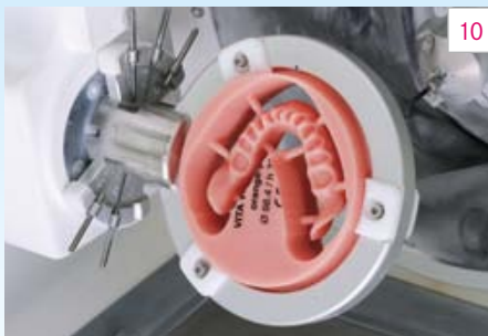
Abb. 10 Die Prothesenbasis wurde aus der PMMA-Ronde VITA VIONIC BASE gefertigt.
