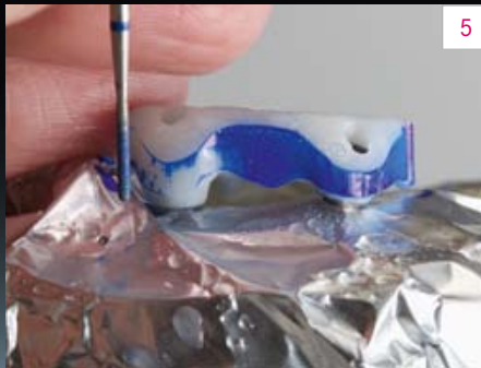
Abb. 5 Die Primärstruktur aus Zirkondioxid wurde auf dem abgedeckten Modell parallel gefräst. Die Friktionsflächen sollten 4 bis 5 Millimeter betragen.
