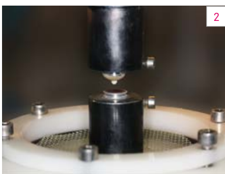
Abb. 2 Der Pin-on-Block (POB) Verschleißtest wurde je Fabrikat an acht verschiedenen Proben mit einer Steatitkugel durchgeführt.
