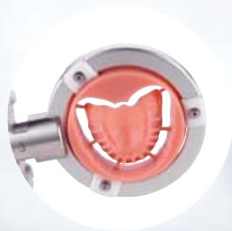
Abb. 4 Die gefräste, definitive PMMA-Basis nach erfolgreicher Wachseinprobe.
