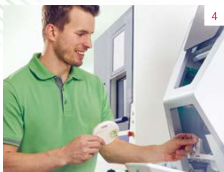
Fig. 4 Insertion d'une pièce brute VITA YZ® ST dans le magasin d'une unité FAO.
