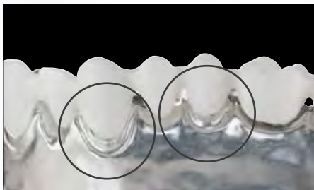
Figura 1b: Controllo visivo della precisione dopo il processo di sinterizzazione per mezzo di modello di precisione di uno ZrO 2 di altro produttore.
