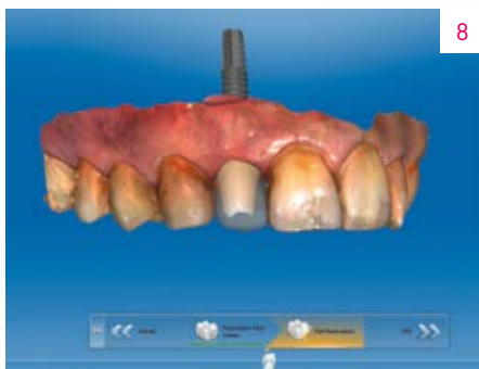
Рис. 8 VITA ENAMIC IS-абатмент и полихромная керамическая коронка (VITABLOCS TriLuxe forte) были смоделированы цифровым способом.
