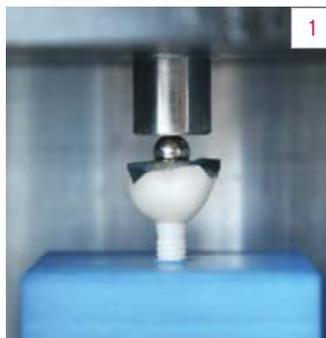
**Fig. 1** Se sometieron las coronas a carga hasta la rotura.
