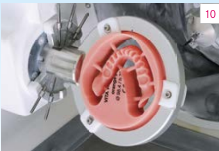
Fig. 10 La base de la prótesis se confeccionó a partir del disco de PMMA VITA VIONIC BASE.
