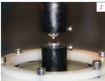
Fig. 2 El ensayo de desgaste “pin-on-block” (POB) se llevó a cabo con ocho muestras distintas por diente utilizando una bola de esteatita.
