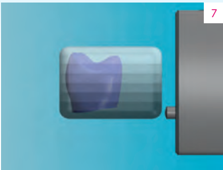
Abb. 7 Mittels vertikaler Positionierung der Krone im virtuellen Rohling konnte der Farbverlauf gezielt gesteuert werden.
