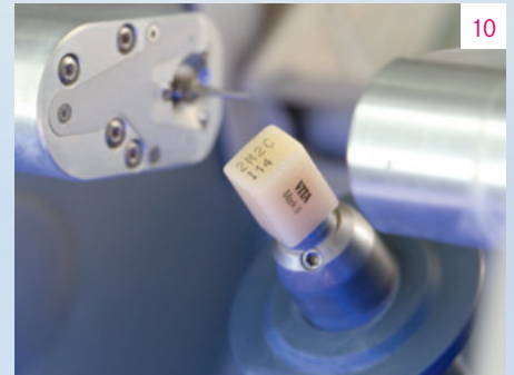
Fig. 10 VITABLOCS Mark II fissato nell'unità di fresaggio.
