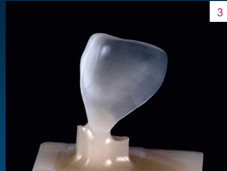
Fig. 3 Risultato altamente preciso dopo il processo di fresaggio con CEREC MC XL.
