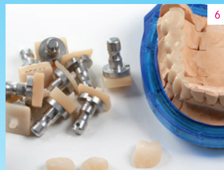
Fig. 6 Le strutture di rivestimento sono state fresate in un'ora con l'unità inLab MC XL.
