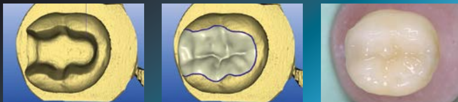
Fig. 1 En la cavidad de un diente de ensayo se fijaron provisionalmente con gel de glicerina inlays realizados en diferentes materiales CAD/CAM.
