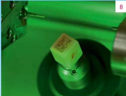
III. 8 Le bloc en céramique hybride hautement translucide en couleur 2M2 inséré dans l'usineuse.
