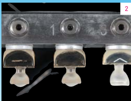
Fig. 2 Al centro la corona CAD/CAM direttamente dopo il fresaggio.
