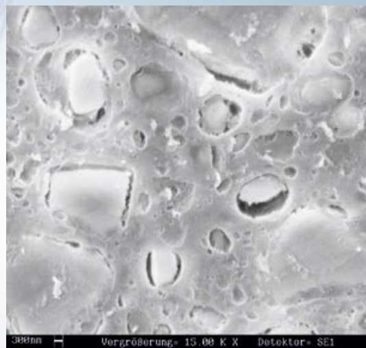
Abb.2 Quelle: VITA F&E, Geätzte Kompositfläche Komposit: Polymer mit keramischen Füllpartikeln
