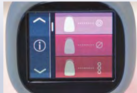
Abb. 1 Hauptmenü des OLED-Farbtouchdisplay. Hier angezeigt: Grundfarbmessung, Mittelmessung und Zahnbereichsmessung.
