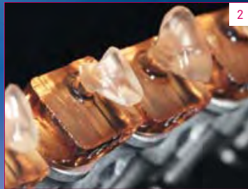
Abb. 2 ... nach der Verarbeitung mit der Fräsmaschine Ceramill Motion 2.
